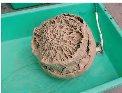
写真-5 ケース 2 固結形状 (b) 固結状況 (下部より撮影)
